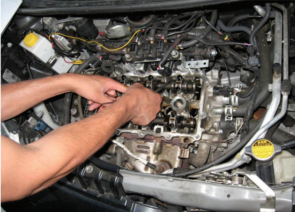
Abbildung / Picture 1: Ventilspielmessung / Measurement of valve clearance
